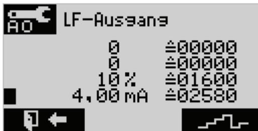
Alle Werte die in der Hardwarediagnose geändert werden, setzt das Steuergerät beim Verlassen des Menüs zurück.
