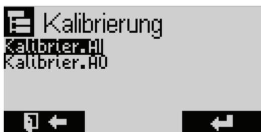
Nach Aufruf des Kalibrieremenüs („Kalibrier. AI“) wird eine Übersichtsmaske aller analogen Eingänge dargestellt. Zur Anzeige kommt neben der Eingangsbezeichnung des aktuell ausgewählten Kanals (oberste Zeile), links der aktuelle Messwert („log.“) sowie rechts der Wandlerwert („phys.“).
