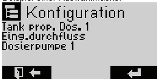
Mit Hilfe der  $\uparrow/\downarrow$ -Tasten wird das zu aktivierende/deaktivierende Modul/Funktion ausgewählt und entweder auf „vorhanden“ bzw. „vorh.“ eingestellt, damit das Modul/Funktion aktiviert ist.
